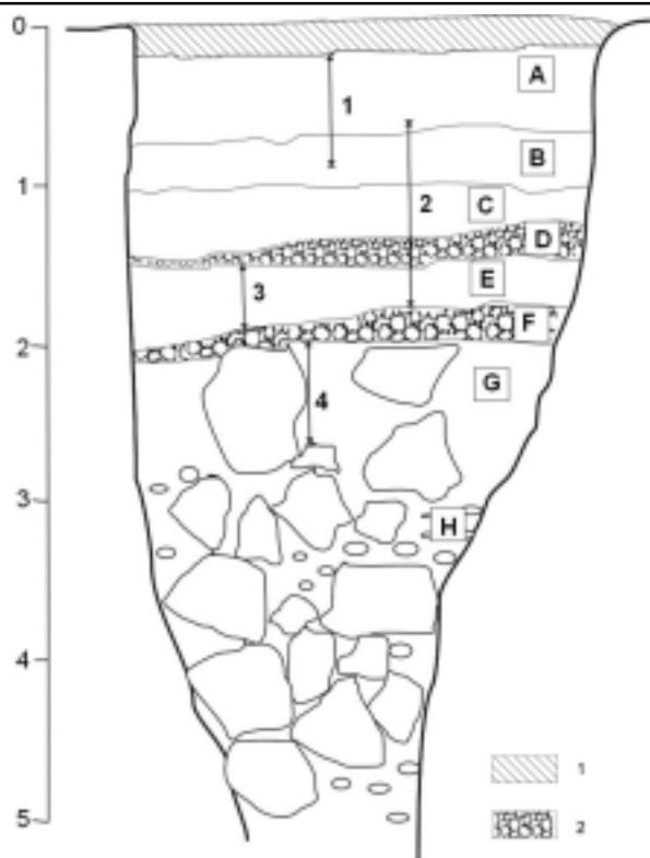
Рис. 2. Схема розрізу BA2 з позначенням літологічних шарів. 1 – техногенні відклади (бетон та щебенева подушка); 2 – щебеневі шари [1].
