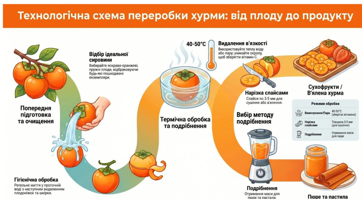
Рис. А.1. Візуалізація технологічної схеми переробки плодів хурми. Схему згенеровано здобувачем вищої освіти в інструменті NotebookLM (Google) на основі аналізу завантажених джерел [5, 12, 17] за методом текстового моделювання; графічне редагування та валідація виконані автором).
