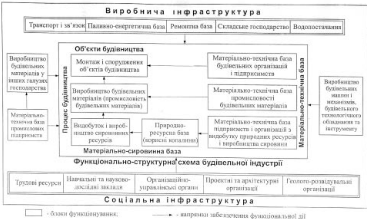
Рис. 2. Принципова блок-схема функціонального забезпечення процесу будівництва.
