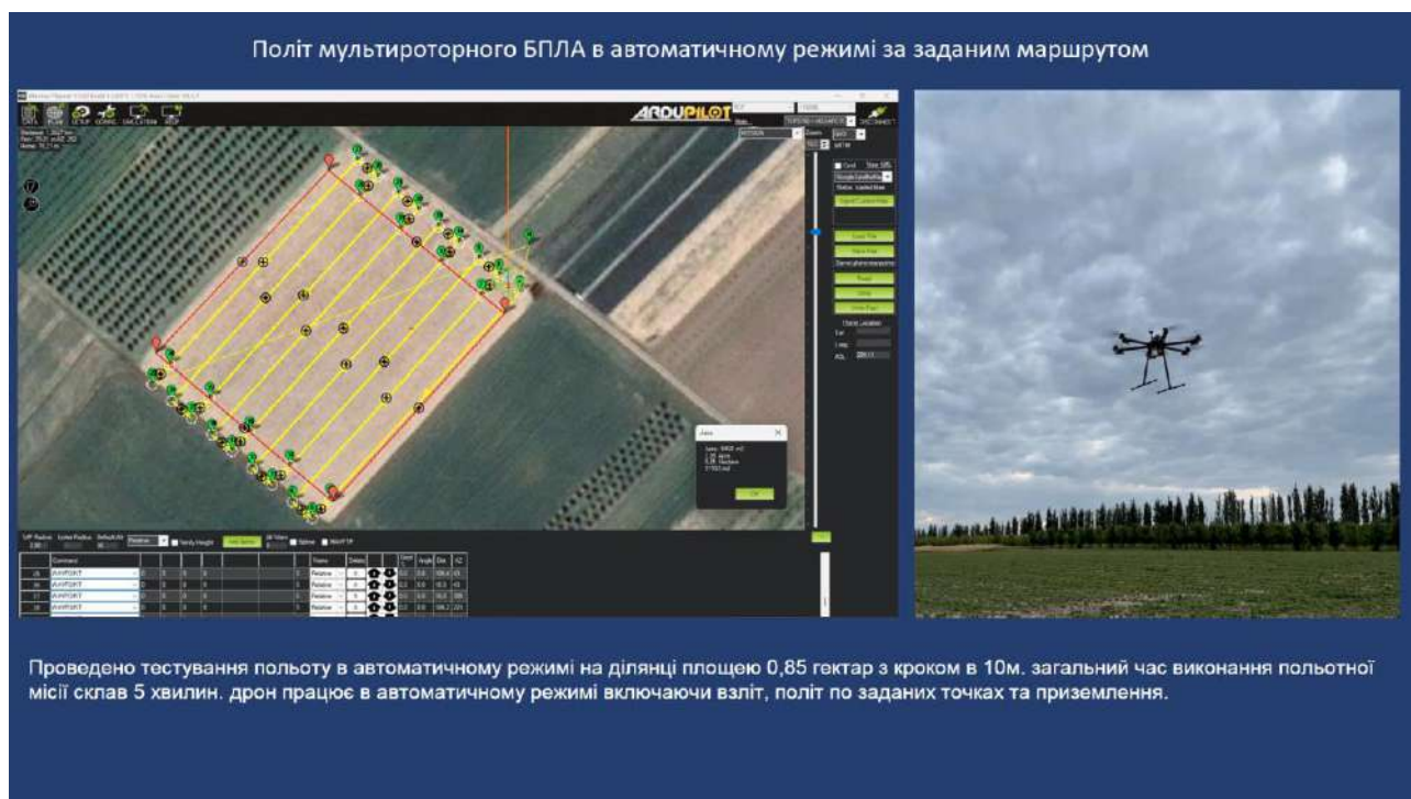
Рис. 6. Експериментальні випробування польотної місії портативного комплексу для наземного аерозондування вибухових закладок
